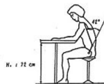
FIGURE N° 23 : - Siège et plan de travail selon les normes actuelles - La flexion lombaire est proche de 40° (d'après MANDAL A.C.)
