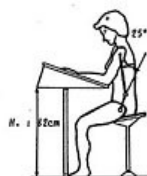
FIGURE N° 24 : - En élevant le siège et le plan de travail de 70 cm, - l'inclinaison de l'assise du siège de 5° vers l'avant - la flexion lombaire est de 25° (d'après MANDAL A.C.)
